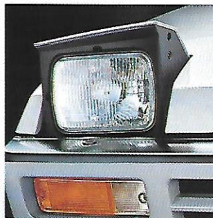
Versenkbare Halogen-Scheinwerfer. Extrem windschlupfrig und im Bruchteil von Sekunden ausfahrbar – auch beim „Lichthupen“.
