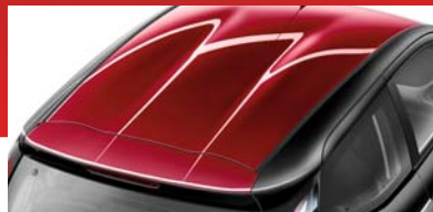
Rot foliertes Dach
