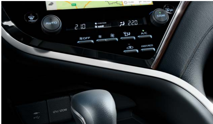
Ein nanoe™-Ionengenerator reinigt die Luft im Fahrzeug, beseitigt Gerüche und inaktiviert Bakterien.
