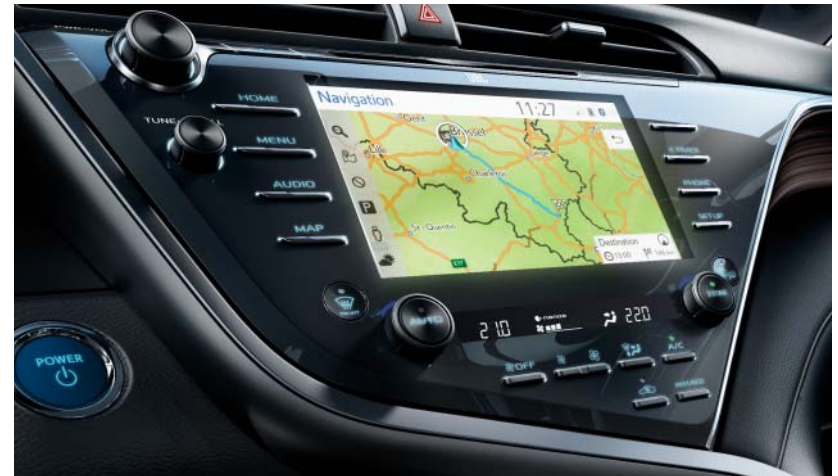
Ein großer Touchscreen dient als Bildschirm für Navigation, Audio-Auswahl und als Monitor der Rückfahrkamera.
