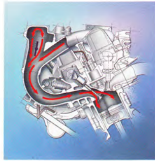
Das variable Ansaugsystem ACIS optimiert im Verbund mit der Mehrventiltechnik die Zylinderfüllung und damit die Leistung.
