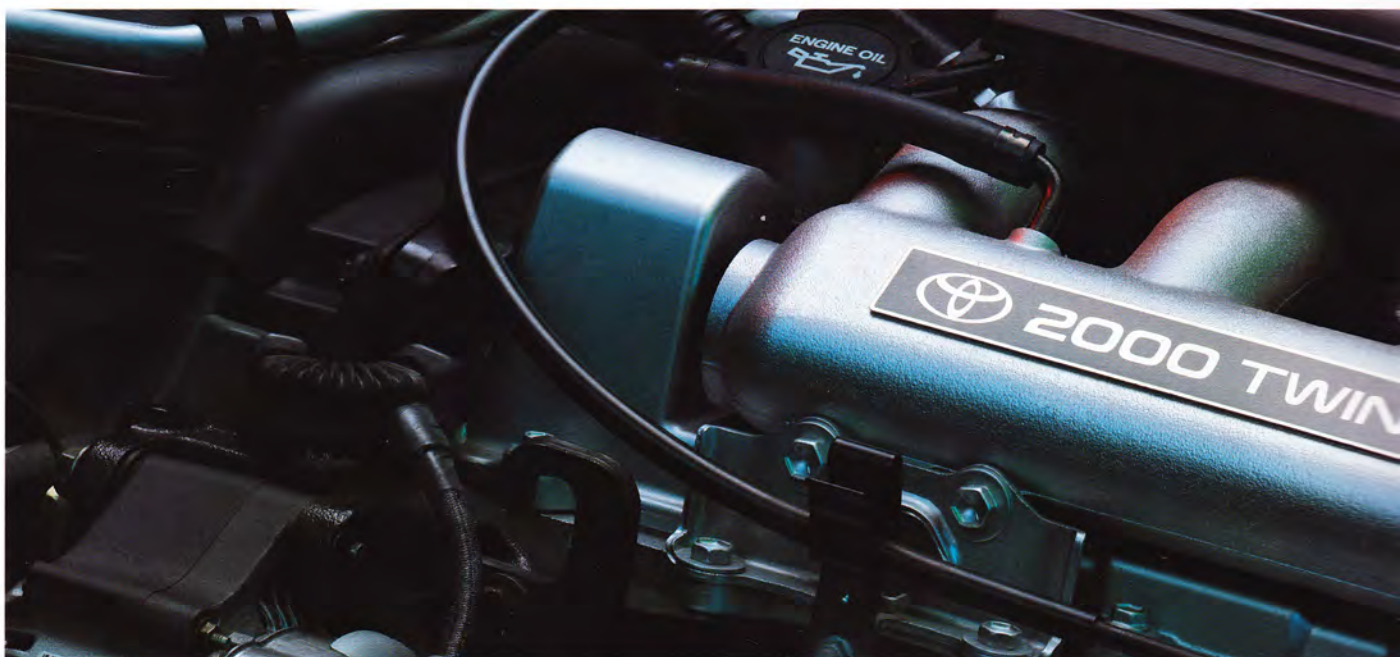
Nicht nur für die Technikbegeisterten unter den Celica Fahrern ein vielversprechender Anblick: der 2-Liter-16-Ventiler im Celica GT.
