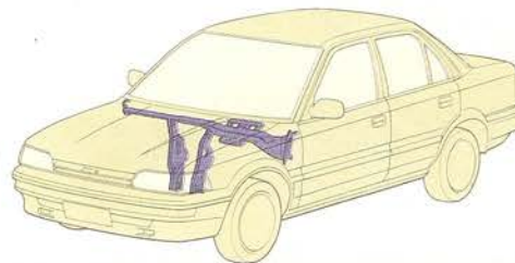
DIE ARMATURENBRETT-VERSTEIFUNG Eine Versteifung im unteren Teil des Armaturenbrettes verringert Lenkvibrationen und trägt wesentlich zum ruhigen Fahrverhalten bei.
