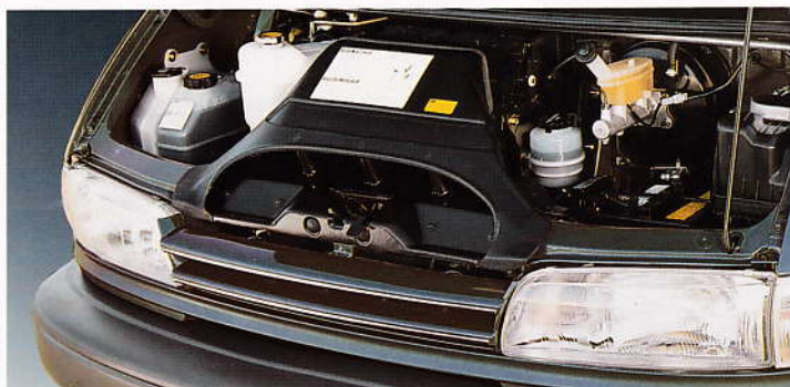
Unter der Fronthaube des Previa herrscht ein ungewöhnliches Bild – hier sind die Service-Aggregate gut erreichbar untergebracht.
