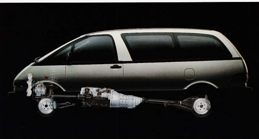
Das Meister- und Mittelstück des neuen Previa ist sein leistungsstarker Unterflur-Motor. Das abgeb. Fahrzeug ist in Deutschland nur mit Dachreling lieferbar.
