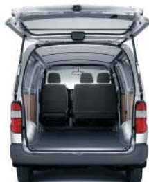
Serienmäßig bietet der Hiace Kasten/Kasten mit langem Radstand eine weit öffnende Heckklappe mit 2fach verstellbarem Öffnungswinkel.
