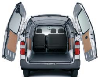
Optional erhältliche Drehflügeltüren beim Hiace Kasten/Kasten mit langem Radstand erleichtern das Laden von Euro-Paletten per Gabelstapler.
