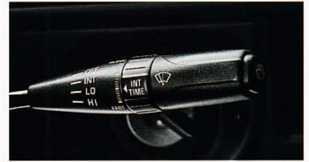
Alles im Griff - der praktische Bedienungshebel mit einstellbarer Intervallschaltung für Scheibenwischer und die Wisch-/Waschanlage.
