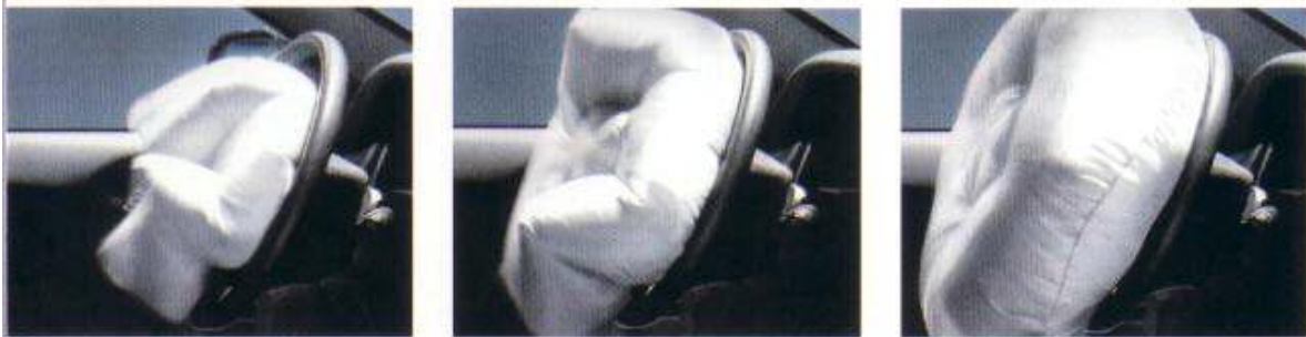
Der Airbag fängt Kopf und Oberkörper des Fahrers wie ein Kissen auf.
