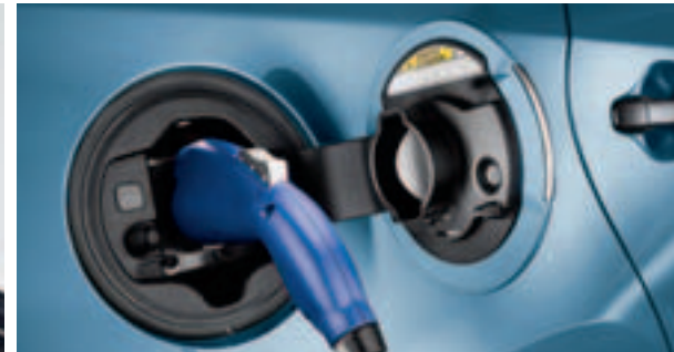
3. Ladesteckdose mit Ladestandsanzeige und Beleuchtung
