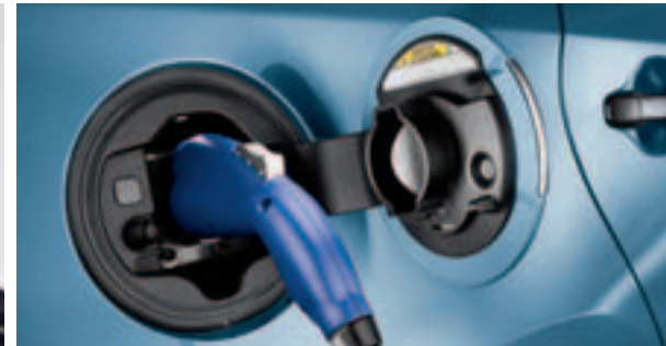
3. Ladesteckdose mit Ladestandsanzeige und Beleuchtung
