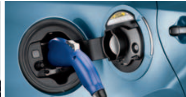
3. Ladesteckdose mit Ladestandsanzeige und Beleuchtung
