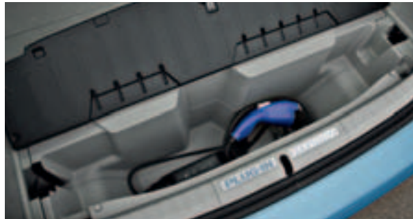
1. Ladekabel (Länge: 5 m) im eigenen Kofferraumfach
