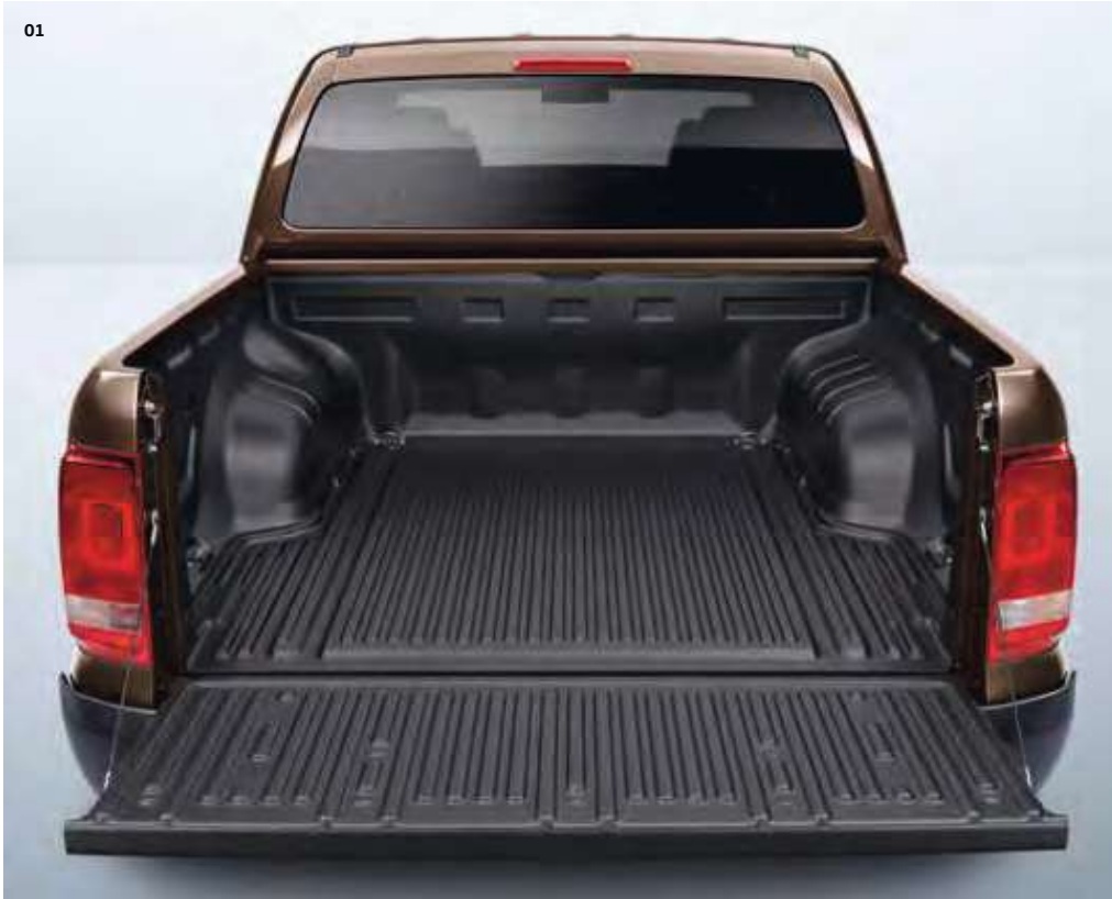
01 Laderaumwanne „underrail“. Die Wanne aus witterungsbeständigem Kunststoff ist ebenso robust wie der Amarok selbst. Sie schließt direkt an die Bordwandkanten an und ist exakt an die Form der Cargobox angepasst. Dadurch schützt sie die Ladefläche und die Heckklappe wirkungsvoll vor sämtlichen Arten von Gebrauchsspuren und Nässe. Natürlich bleibt das Ladevolumen erhalten. | TL | CL | HL |
