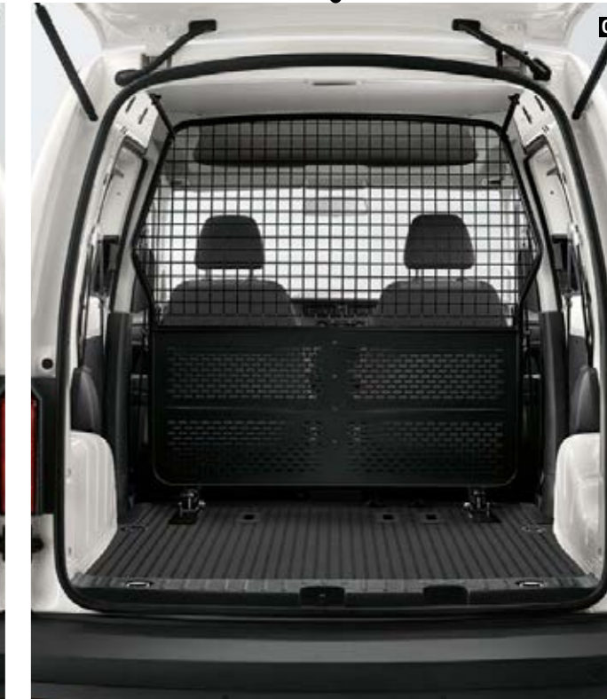
03 Verstellbare Gittertrennwand. 1) Das robuste Gittergeflecht kann in zwei Positionen fixiert werden: hinter der zweiten Sitzreihe an der C-Säule oder hinter der nach vorn gewickelten zweiten Sitzreihe.
