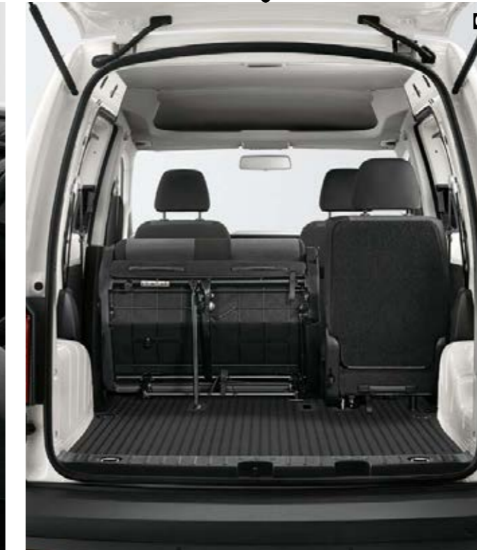
02 Klapp- und wickelbare 3er-Sitzbank. Die Sitzbank in der zweiten Sitzreihe setzt sich aus einem Einzelsitz und einer 2er-Sitzbank zusammen. Beide Elemente können unabhängig voneinander geklappt, gewickelt und herausgenommen werden. Wird die 3er-Sitzbank im Ganzen ausgebaut, ergibt sich eine großzügige ebene Ladefläche.
