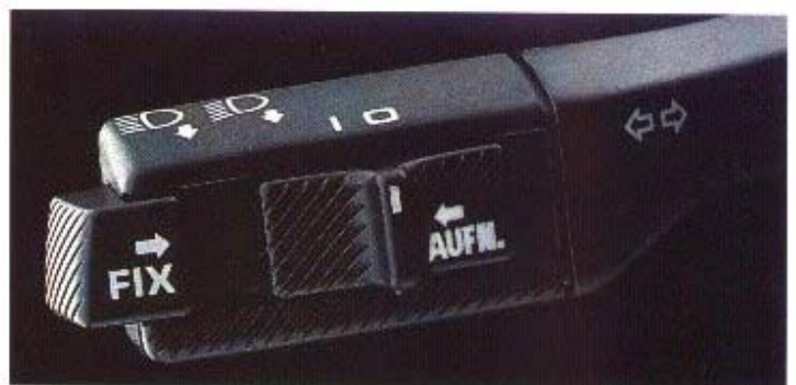
Die Geschwindigkeits-Regelanlage. Zur Programmierung der gewünschten Geschwindigkeit. Der Fahrer kann jede Geschwindigkeit ab 40 km/h als Konstante eingeben.
