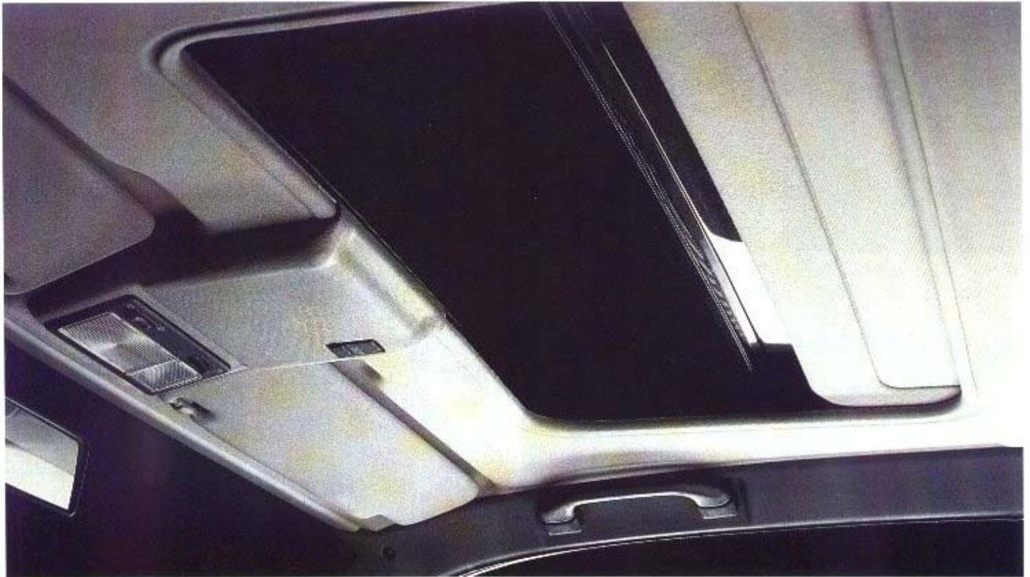
Das Schiebe-/Ausstelldach. Elektrisch zu betätigen. Öffnen oder aufsteigen des hinteren Teils. Mit selbstaufstellendem Windschleier gegen Zugluft.
