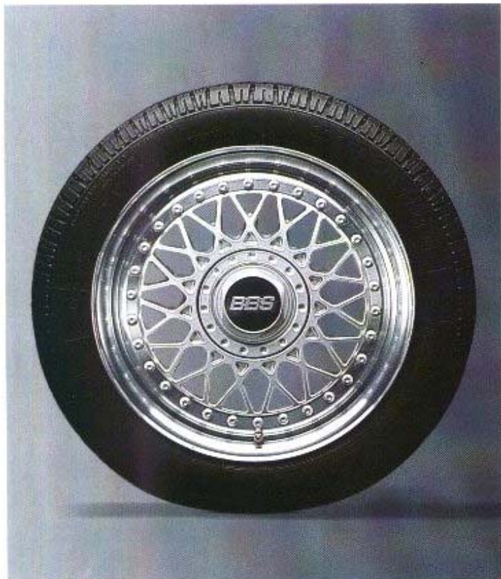
Das mehrteilige BBS-Leichtmetallrad 6½ J x 15. Mit Breitreifen der Größe 195/50 R 15 V. Sportliches Design, geringes Gewicht.
