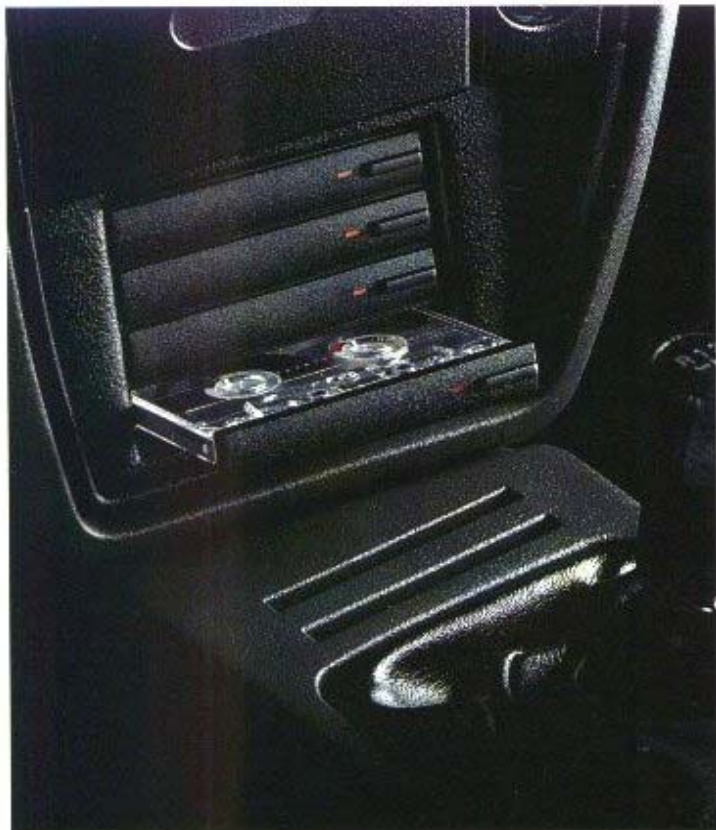
Die beleuchtete Cassettenablage. Mit optischer Belegungsanzeige und Spulenansteuerung gegen Bandsalat.
