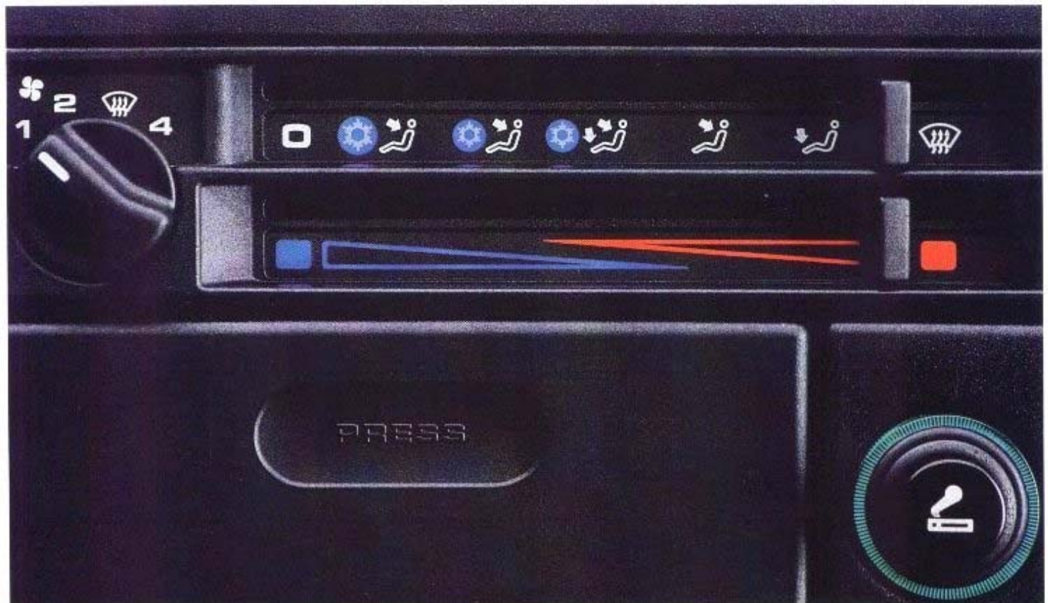
Die Klimaanlage. Besonders hohe Kühlleistung. Wahlweise Frischluft- oder z.B. im Stau, Umluftbetrieb. Wirkungsvoller Zusatzeffekt: Die Scheiben bleiben beschlagfrei.
