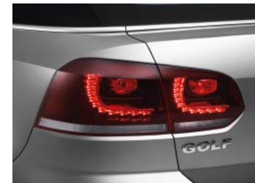
03 DUNKELROTE RÜCKLEUCHTE IN LED-TECHNIK | S
