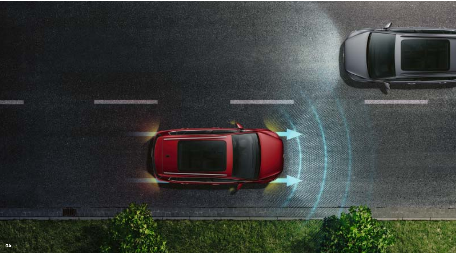
04 Seien Sie im Notfall vorbereitet – mit dem Assistenzsystem „Emergency Assist“ , das einen Teil der Fahrzeugsteuerung im medizinischen Notfall übernehmen kann. 1) Es kann aktiv werden, wenn keine Aktivität des Fahrers mehr registriert wird. Kann das System trotz Warnung keine Reaktion feststellen, kann es versuchen, sowohl den Fahrer zu reaktivieren als auch die Mitfahrer und andere Verkehrsteilnehmer zu warnen. 1) Findet keine Übernahme der Steuerung statt, kann das System das Fahrzeug in der Spur halten und bis zum Stillstand abbremsen. 1) SO
