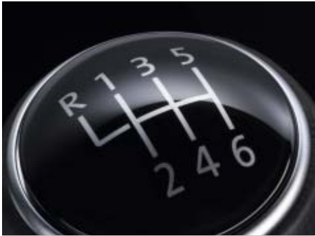
Das 6-Gang-Schaltgetriebe ist voll synchronisiert und damit leicht zu schalten. So bleiben Sie bequem im richtigen Drehzahlbereich.
