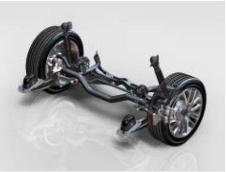
Eine Mehrlenkerachse wie die Vierlenker-Hinterachse im Golf Variant ist vor allem für die Fahrdynamik von Vorteil, denn sie kann optimal auf die äußeren Gegebenheiten abgestimmt werden.
