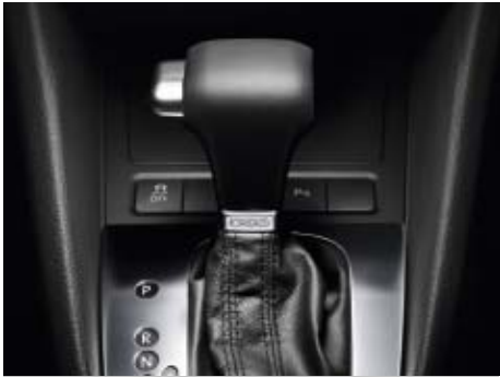
Ein Meilenstein in der Entwicklung des Getriebebaus ist das Doppelkupp- lungsgetriebe DSG. Dieses Automatikgetriebe wechselt in wenigen Hundertstel- sekunden nahezu unmerklich und ohne Zugkraftunterbrechung in den bereits vorgewählten nächsten Gang.
