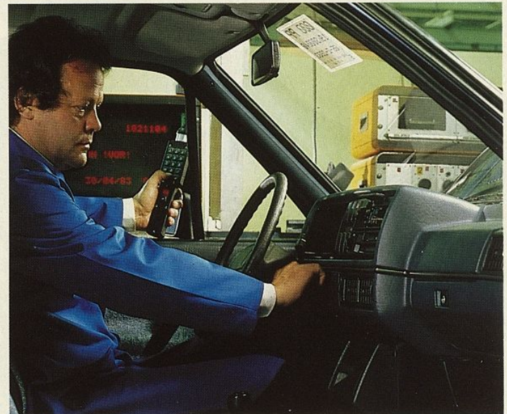
Die Qualitäts-Endkontrolle der elektrischen Anlage.
