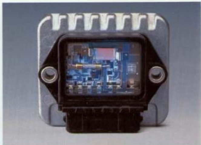
Das Schaltgerät der elektronischen Zündanlage. Zuverlässig starten mit der Transistor-Zündung (TSZ), auch bei ungünstigen Witterungsverhältnissen. Die Zündanlage arbeitet kontaktlos und ist damit, abgesehen von den Longlife-Zündkerzen, wartungsfrei. Der kräftige Zündfunke sorgt für sichere Verbrennung und damit gute Ausnutzung des Kraftstoff-Luft-Gemisches.
