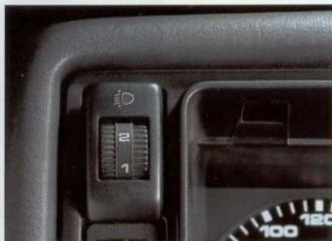
Die Leuchtweitenregulierung. Exakte, elektrische Höhenregulierung der Scheinwerfer je nach Beladung. Mögliches Blenden des Gegenverkehrs wird vermieden.
