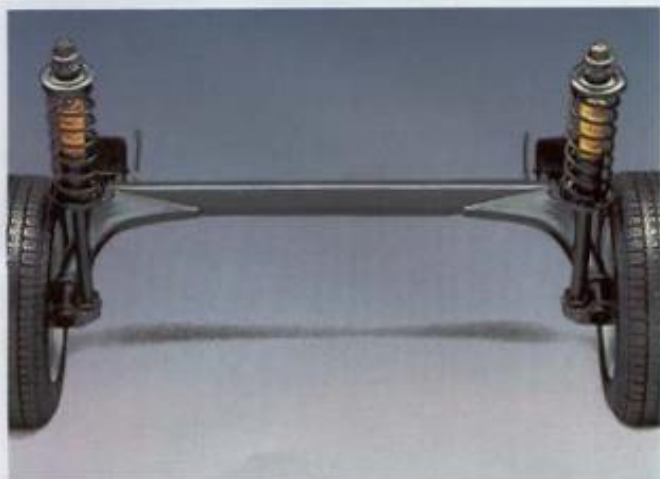
Die Verbundlenker-Hinterachse. Fahrsicherheit bei gleichzeitigem Fahrkomfort – die Verbundlenker-Hinterachse macht's möglich. Auf gerader Straße reagieren die Lager aus Metall und Gummi angenehm weich, was hohen Fahrkomfort ergibt. Und in Kurven stemmen sie sich den Seitenkräften fahrstabilisierend entgegen. Eigenschaften, die übrigens auch bei Vollbelastung gelten.
