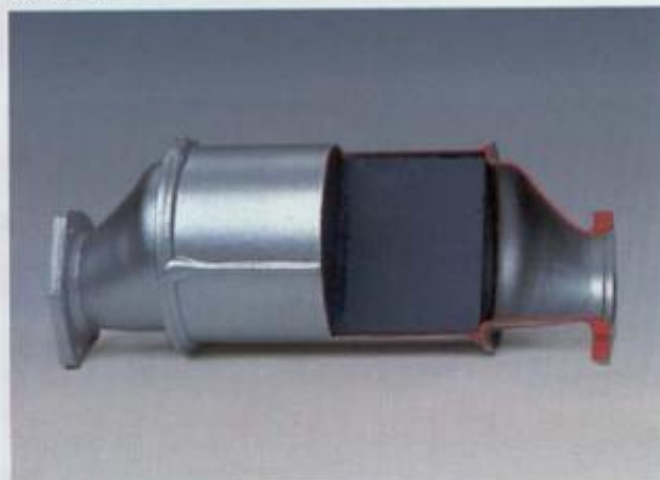
Der Katalysator. Umweltfreundlich fahren mit Katalysator. Er vermindert die Schadstoffe im Abgas und ist besonders wirksam in Verbindung mit der Lambda-Regelung.
