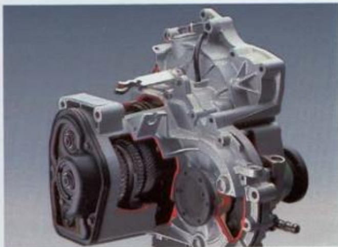
Das 4+E-Schaltgetriebe. Neben den speziellen Vorteilen dieses 5-Gang-Getriebes (Drehzahlabsenkung mit sich daraus ergebender Geräusch- und Verschleißminderung sowie Kraftstoffersparnis) sind hier die Antriebswellen mit Kegeirollenlagern besonders robust gelagert, mit dem Vorteil der noch höheren Beanspruchbarkeit und Lebensdauer.
