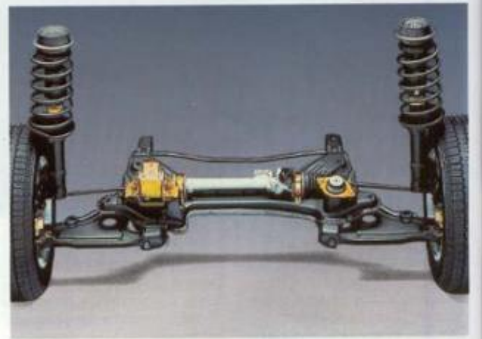
Die Federbein-Vorderachse. Sichere Straßenlage. Hoher Fahrkomfort. Leichte Lenkbarkeit. Zusätzlich ermöglicht der spurstabilisierende Lenkrollradius weitgehend ein Beibehalten der Fahrtrichtung, wenn der Wagen z.B. beim Bremsen mit den Rädern einer Seite auf losen Untergrund gerät.
