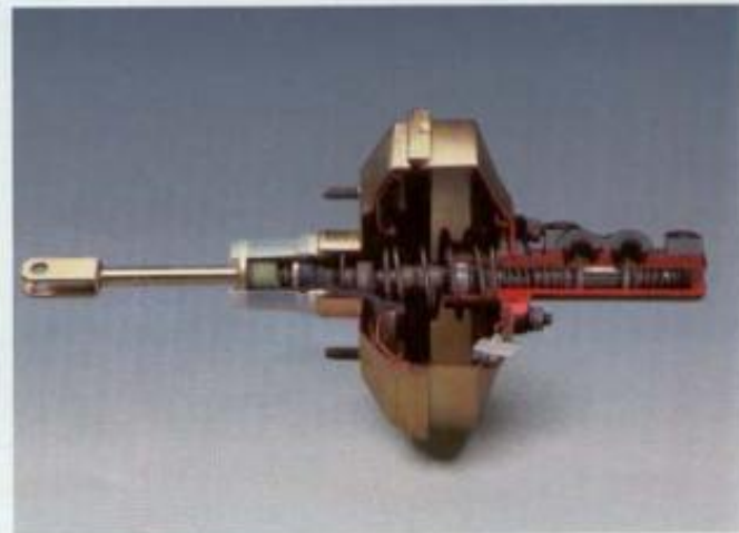
Der Bremskraftverstärker. Mit geringem Kraftaufwand sanft und zuverlässig bremsen. Der vom Motor im Ansaugrohr erzeugte Unterdruck wird durch den Bremskraftverstärker zur Unterstützung der Pedalkraft genutzt.
