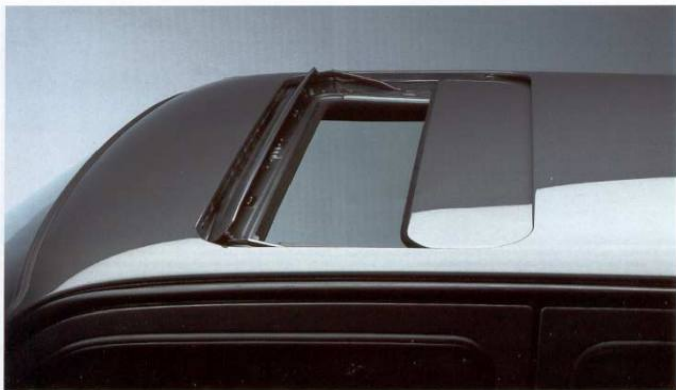
Das Schiebedach. Mit selbstaufstellendem Windabweiser gegen Zugluft.
