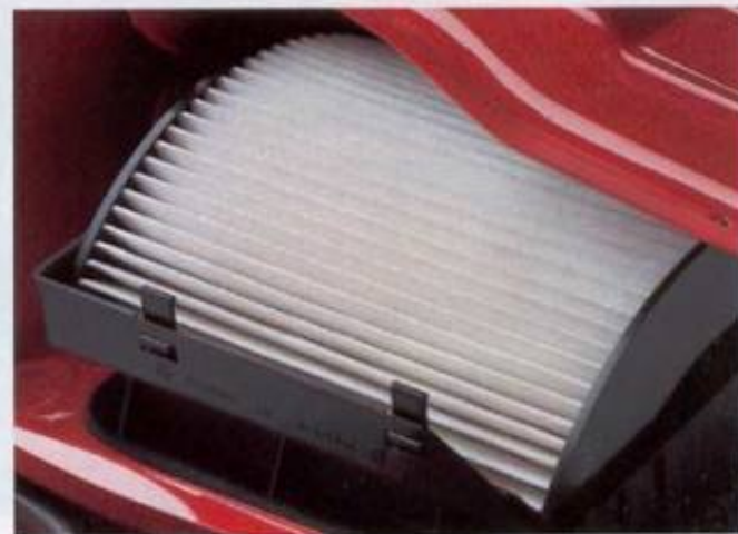
Der Staub- und Pollenfilter. Er reinigt die angesaugte Außenluft von Pollen- und Staubpartikeln und verbessert so die Luft im Fahrgastraum.
