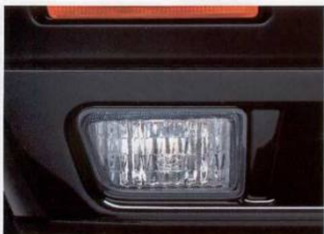
Die Halogen-Nebelscheinwerfer. Bessere Sicht bei Nebel und starkem Schneefall (Abb. zeigt Nebelscheinwerfer des GL in DE-Technik).
