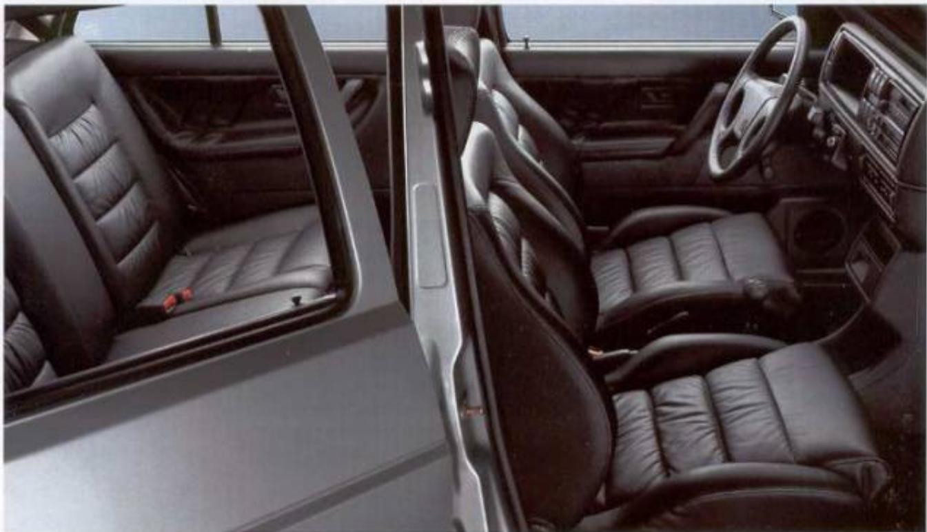
Die Leder-innenausstattung. Sitzmittelbehn und -wangen sowie Kopfstützer vorderer Teil in Leder. Ledereinsatz in Tür- und Seitenverkleidungen. Lenkradkranz, Schalthebelknopf und Handbremshebel mit Lederbezug.
