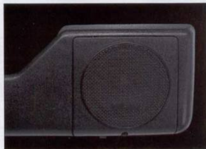
Die Aktiv-Lautsprecher. Noch mehr Volumen für „gamma“ durch ein Mehrwege-Soundsystem. Bestehend aus je 2 Aktiv-Lautsprechern in der Armaturentafel, in den Türablagekästen (Baßreflexbox) und im Fahrzeugheck. (Serie bei „gamma CD.“)
