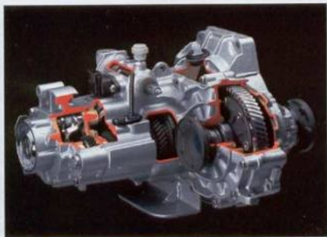
Das 5-Gang-Schaltgetriebe. Neben den speziellen Vorteilen eines 5-Gang-Getriebes (Drehzahlabsenkung mit sich daraus ergebender Geräusch- und Verschleißminderung sowie Kraftstoffersparnis) sind hier die Antriebswellen mit Kegelrollenlagern besonders robust gelagert, mit dem Vorteil der noch höheren Beanspruchbarkeit und Lebensdauer.
