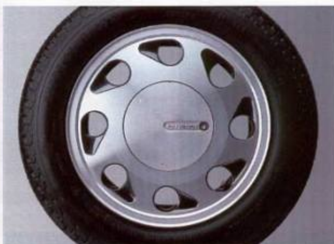
Das Leichtmetallrad Silverstone 6 J x 14. Mit Mittenabdeckung und Breitreifen der Größe 185/60 R 14. Sportliches Design. Geringeres Gewicht.
