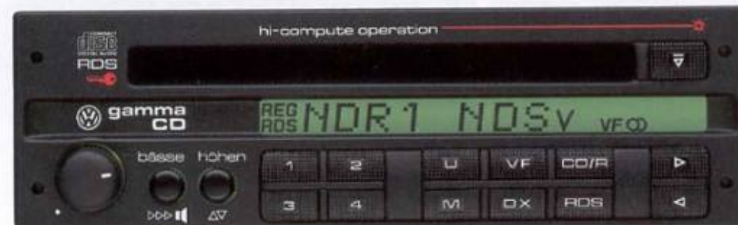
Das Radio-CD-Gerät „gamma CD“. Mit UKW-Stereo-/MW-Empfangsteil, 4 Stationstasten für je 4 MW-/UKW-VF-Sender, Radio-Data-System (RDS) inkl. Verkehrsfunk- einrichtung, getrennter Höhen- und Tiefenregelung, Tippastenbedienung, Display in Punktmatrix-Darstellung, Antidiebstahl-Codierung, CD-Laufwerk mit 1-Strahl-Laser-
