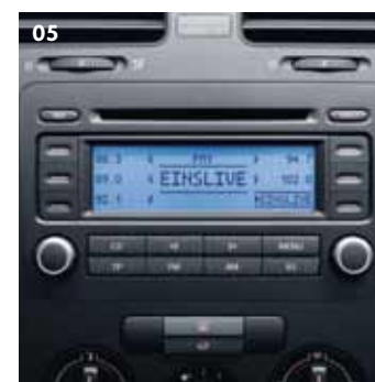
05 Das Radiosystem RCD 300 mit Titelwahl, Zufallstitelwahl und Anspielautomatik lässt sich leicht bedienen – und bietet höchsten Musikgenuss. Dafür sorgen ein CD-Player, sechs Lautsprecher vorn und 2x 20 Watt Ausgangsleistung. Gegen Aufpreis erhalten Sie optional das Radiosystem RCD 300 plus mit zehn Lautsprechern und 4x 20 Watt Ausgangsleistung.
