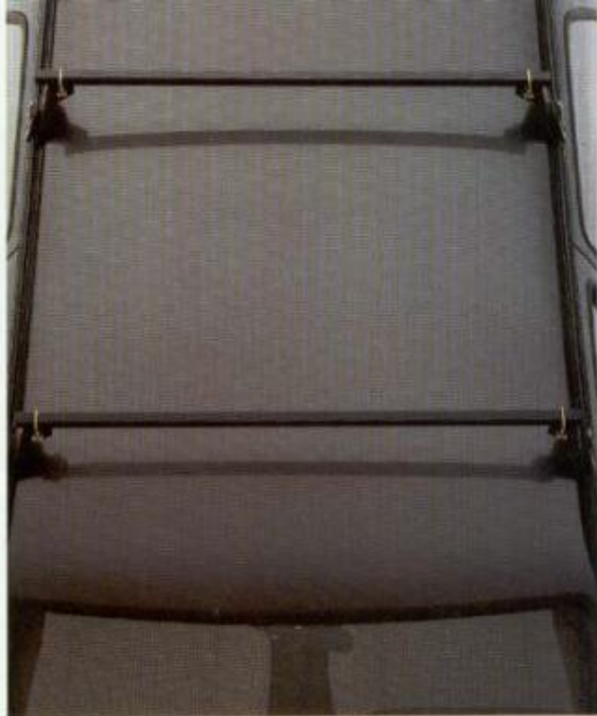
Das Grundträgerelement für Ski-, Surfbrett- und Fahrradhalter.
