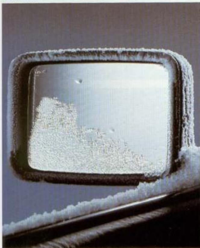
Der elektrisch einstellbare und beheizbare Außenspiegel.
