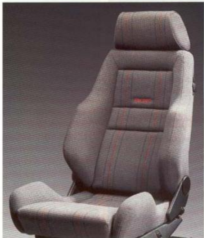
Die Recaro Sportsitzausstattung. Noch mehr Sitz- und Bedienungskomfort mit elektrischer Höheneinstellung. Tür- und Seitenverkleidungen werden auf das Dessin der Sitzbezüge abgestimmt.
