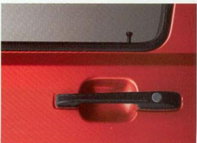
Die Zentralverriegelung. Sicherer und bequemer geht's nicht. Die Türen, der Gepäckraum und die Tankklappe werden automatisch verriegelt. Die Beifahrertür lässt sich separat öffnen.
