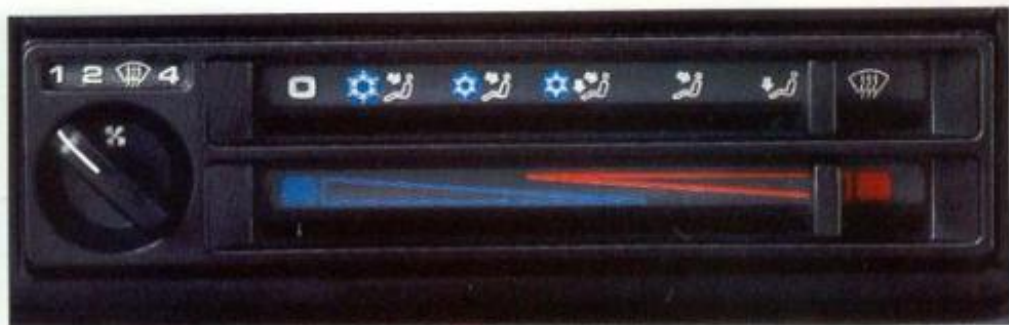
Die Klimaanlage. Besonders hohe Kühlleistung. Wahlweise Frischluft- oder z.B. im Stau, Umluftbetrieb. Wirkungsvoller Zusatzeffekt: Die Scheiben bleiben beschlagfrei.
