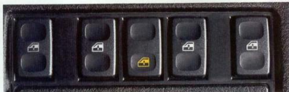
Die elektrischen Fensterheber. Alle Seitenscheiben per Knopfdruck öffnen und schließen. Mit Kindersicherung für die hinteren Fenster.
