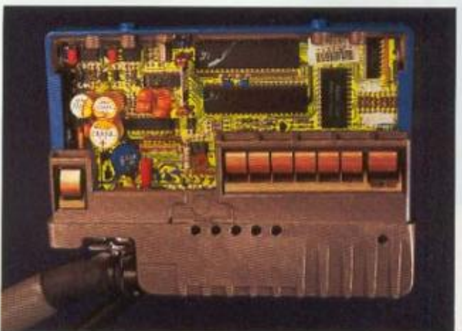
Das Steuergerät für ABS. Das Steuergerät verarbeitet die eingehenden Informationssignale der Drehzahlgeber und gibt die Stellbefehle an die Magnetventile. Außerdem überwacht es laufend die Funktion des Anti-Blockier-Systems.
