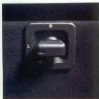
Die elektrisch einstellbaren Außenspiegel. Bequem zu bedienen. Beheizbar mit Heckscheibe.
