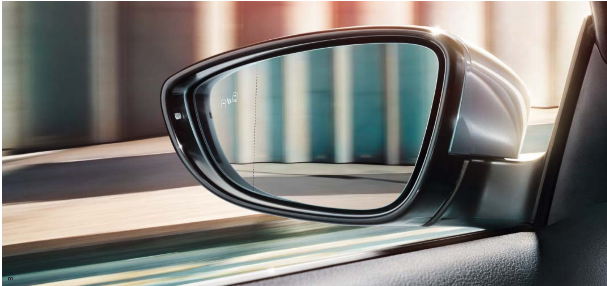
01 „Blind Spot“-Sensor mit Ausparkassistent Der „Blind Spot“-Sensor beobachtet – im Rahmen der Grenzen des Systems – das Umfeld auf beiden Seiten des Fahrzeugs und kann so vor anderen Verkehrsteilnehmern im toten Winkel warnen. Damit erleichtert er Ihnen zum Beispiel den Spurwechsel bei Überholvorgängen. SO
