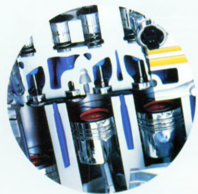
Aus einem Guß: Auch der Motorblock ist vollständig aus Aluminium.
