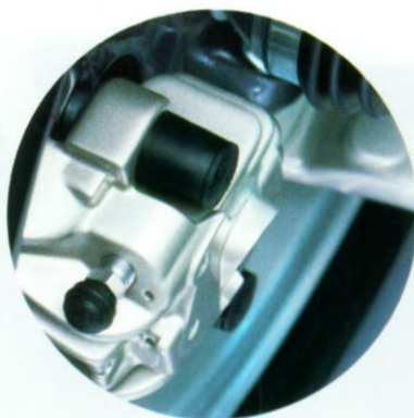
Standfest: Leichtmetall-Bremssättel an den vorderen Scheibenbremsen.
