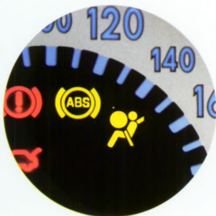
Damit bleibt der 3-Liter-Lupo auch beim Bremsen lenkbar: das Anti-Blockier-System (ABS).
