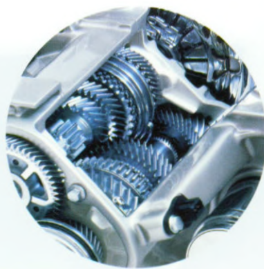
Leichtgewicht: das Direktschaltgetriebe mit Aluminiumgehäuse.
