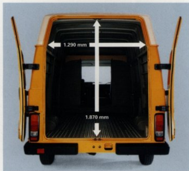
Große Türöffnungen erleichtern das Laden auch größerer Paletten. Laderaumhöhe: 1.870 mm. Türen mit 265° Öffnungswinkel erleichtern den Ladevorgang auf engstem Raum.
