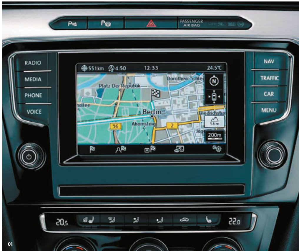
01 Das Navigationssystem „Discover Media“ für das Radiosystem „Composition Media“ ist mit einem 16,5 cm (6,5 Zoll) großen TFT-Farbdisplay, installiertem Kartenmaterial für Europa, einem Touchscreen mit Annäherungssensorik und einem MP3- und WMA-fähigen CD-Player mit sechs Lautsprechern ausgestattet. Zudem verfügt das System über zwei SD-Kartenschächte, eine AUX-IN-Buchse, eine USB-Schnittstelle sowie eine Bluetooth-Anbindung für Mobiltelefone. Im Display kann unter anderem die Außentemperatur angezeigt werden. Und mit der integrierten WLAN-Funktion und den mobilen Onlinediensten „Car-Net“ sind Sie auch unterwegs immer bestens vernetzt. SO
