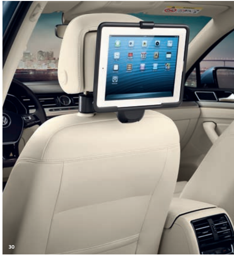
27–31 Ein Halter, viele Möglichkeiten: Das innovative modulare Reise- und Komfortsystem ist ein echter Alleskönner und trägt zu einem aufgeräumten und übersichtlichen Fahrzeuginnenraum bei. Es besteht aus einem Basismodul , welches zwischen den Kopfstützenstreben der Vordersitze befestigt wird, und verschiedenen separat erhältlichen Zusatzmodulen, die sich je nach Anforderung einfach am Basishalter befestigen und flexibel gegeneinander austauschen lassen. So reisen Sie von nun an mit praktischen Modulen wie dem portablen Kleiderbügel , einem robusten Taschenhaken , dem schwenkbaren Tablethalter für Modelle diverser Hersteller oder einem verstellbaren Klapptisch mit Becherhalter immer erster Klasse. SO
