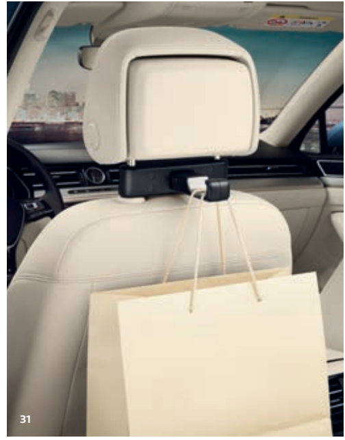
27–31 Ein Halter, viele Möglichkeiten: Das innovative modulare Reise- und Komfortsystem ist ein echter Alleskönner und trägt zu einem aufgeräumten und übersichtlichen Fahrzeuginnenraum bei. Es besteht aus einem Basismodul , welches zwischen den Kopfstützenstreben der Vordersitze befestigt wird, und verschiedenen separat erhältlichen Zusatzmodulen, die sich je nach Anforderung einfach am Basishalter befestigen und flexibel gegeneinander austauschen lassen. So reisen Sie von nun an mit praktischen Modulen wie dem portablen Kleiderbügel , einem robusten Taschenhaken , dem schwenkbaren Tablethalter für Modelle diverser Hersteller oder einem verstellbaren Klapptisch mit Becherhalter immer erster Klasse. SO
