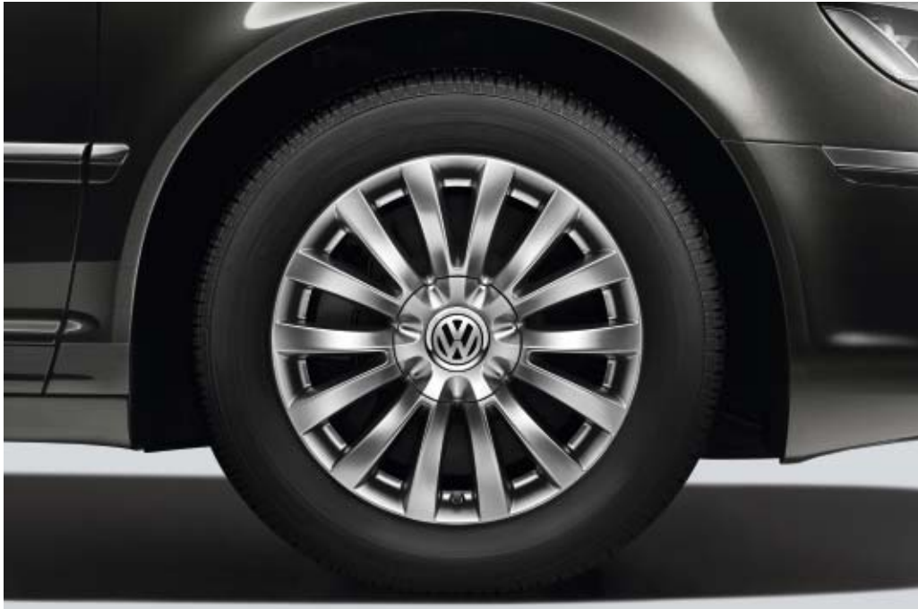
Vier Leichtmetallräder „Impression“, 7½ J x 17, Reifen 235/55 R 17, in Sterling-Silber lackiert.
