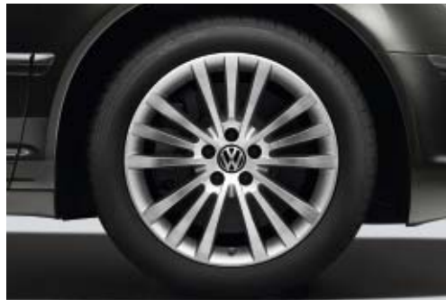
Vier Leichtmetallräder „Spirit“, 8½ J x 18, Reifen 255/45 R 18, in Sterling-Silber lackiert.
