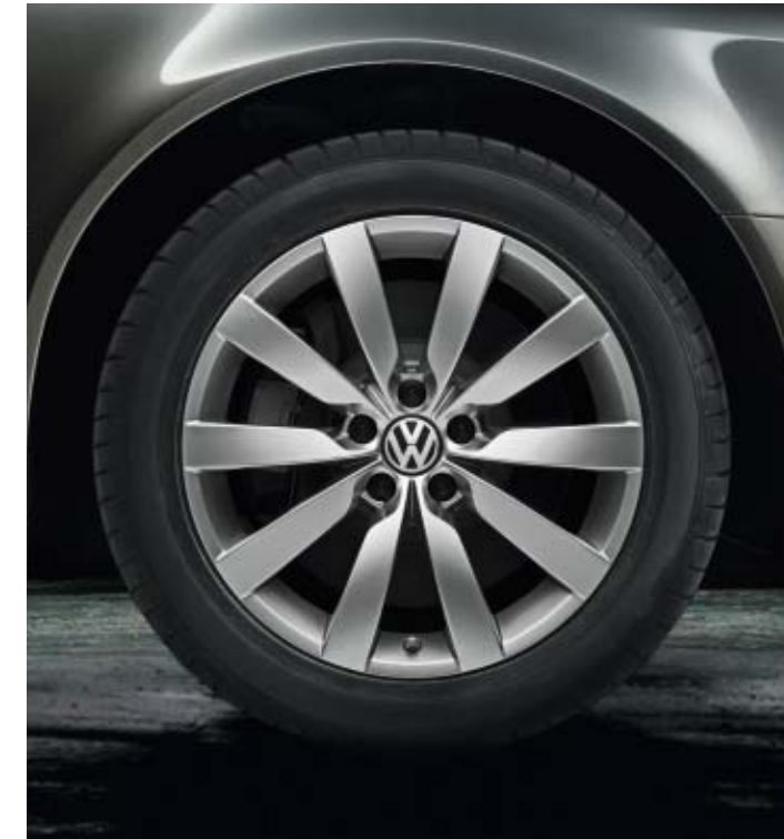
Leichtmetallräder „Experience“, 8½ J x 18, Reifen 255/45 R 18, in Sterling-Silber lackiert.
