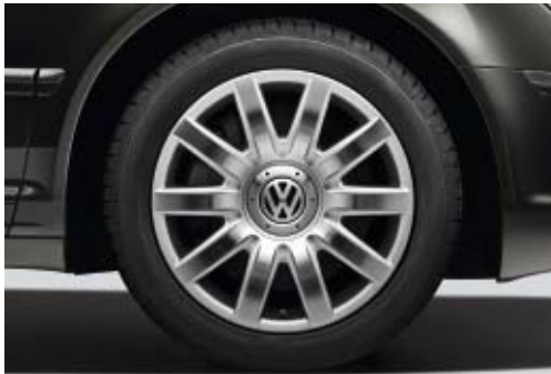
Vier Leichtmetallräder „Aristoteles“, Volkswagen R GmbH, 8,5 J x 18, Reifen 255/45 R 18, Oberfläche glanzgedreht.
