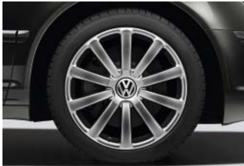
Vier Leichtmetallräder „Omanyt“, Volkswagen R GmbH, 9 J x 19, Reifen 255/40 R 19, Felgenhorn glanzgedreht.
