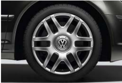
Vier Leichtmetallräder „Helios“, Volkswagen R GmbH, 8,5 J x 19, Reifen 255/40 R 19, in Sterling-Silber lackiert.
