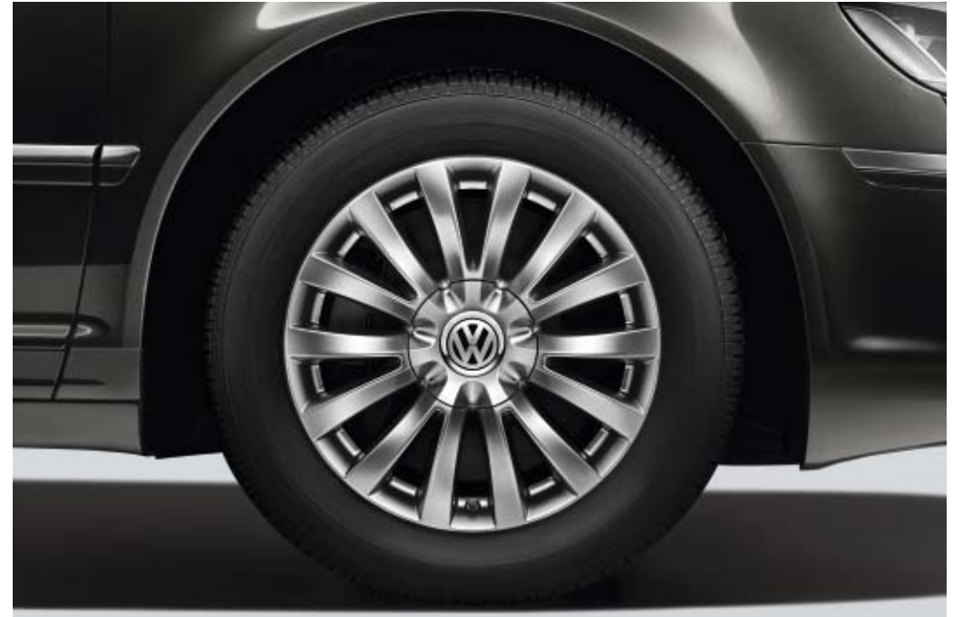
Vier Leichtmetallräder „Impression“, 7,5 J x 17, Winterreifen 235/55 R 17 H, zusätzlich zur gewählten Sommerbereifung.
