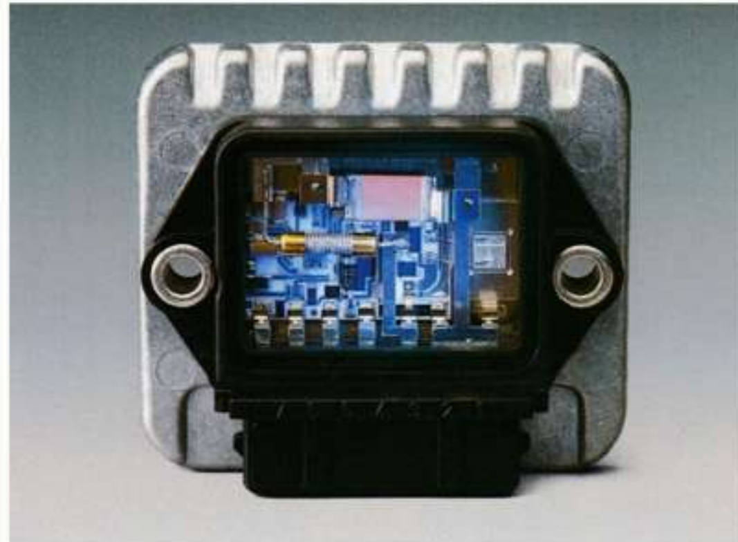
Das Schaltgerät der elektronischen Zündanlage. Zuverlässig starten mit der Transistor-Zündung (TSZ), auch bei ungünstigsten Witterungsverhältnissen. Die Zündanlage arbeitet kontaktlos und ist damit, abgesehen von den Longlife-Zündkerzen, wartungsfrei. Der kräftige Zündfunke sorgt für sichere Verbrennung und damit gute Ausnutzung des Kraftstoff-Luft-Gemisches.
