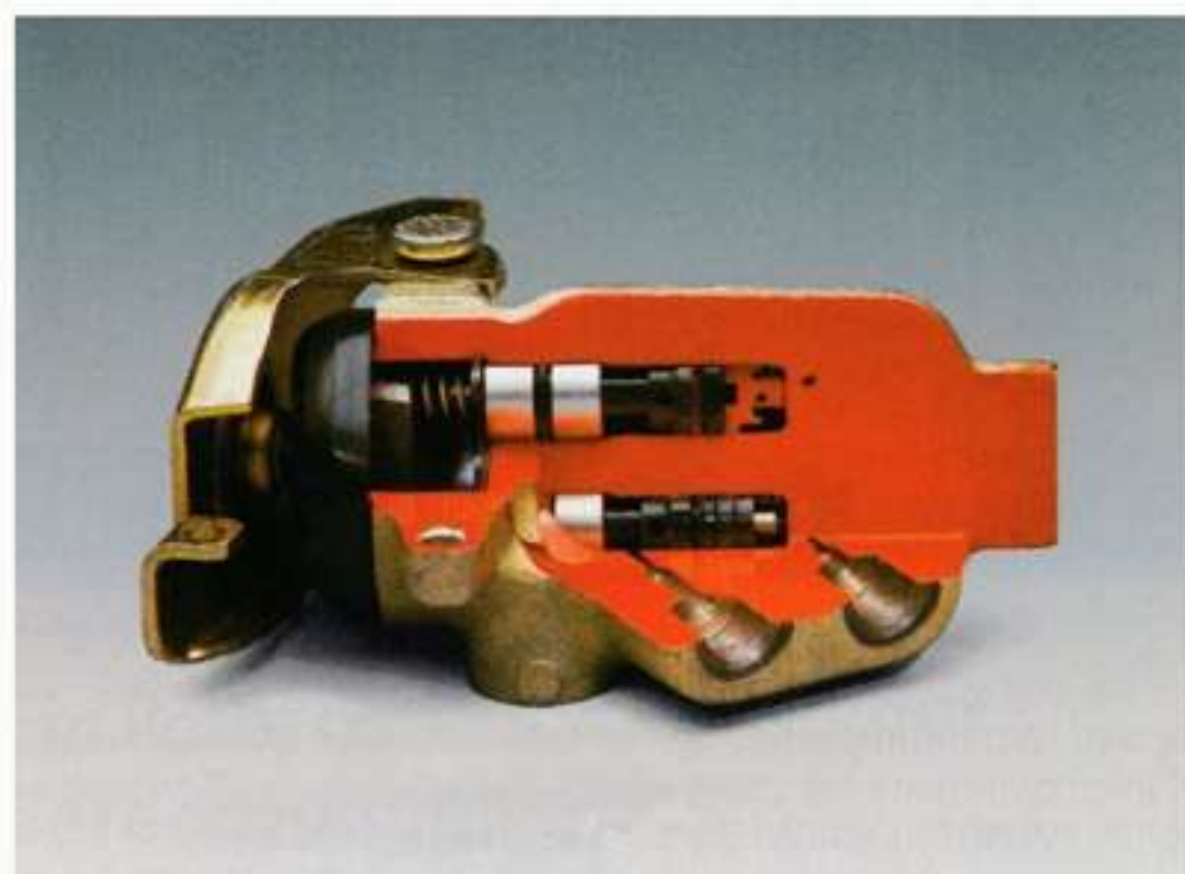
Der Bremskraftregler. Sicheres Bremsen bei jedem Belastungszustand. Er sorgt dafür, daß das Verhältnis der Bremskräfte an den jeweiligen Achsen dem Belastungszustand angepaßt ist.
