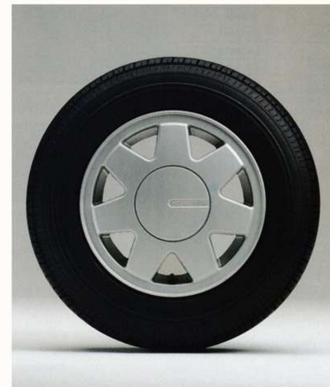
Das Leichtmetallrad 5½ J x 13. Mit Mittenabdeckung und Reifen der Größe 165/65 SR 13. Sportliches Design. Geringeres Gewicht.
