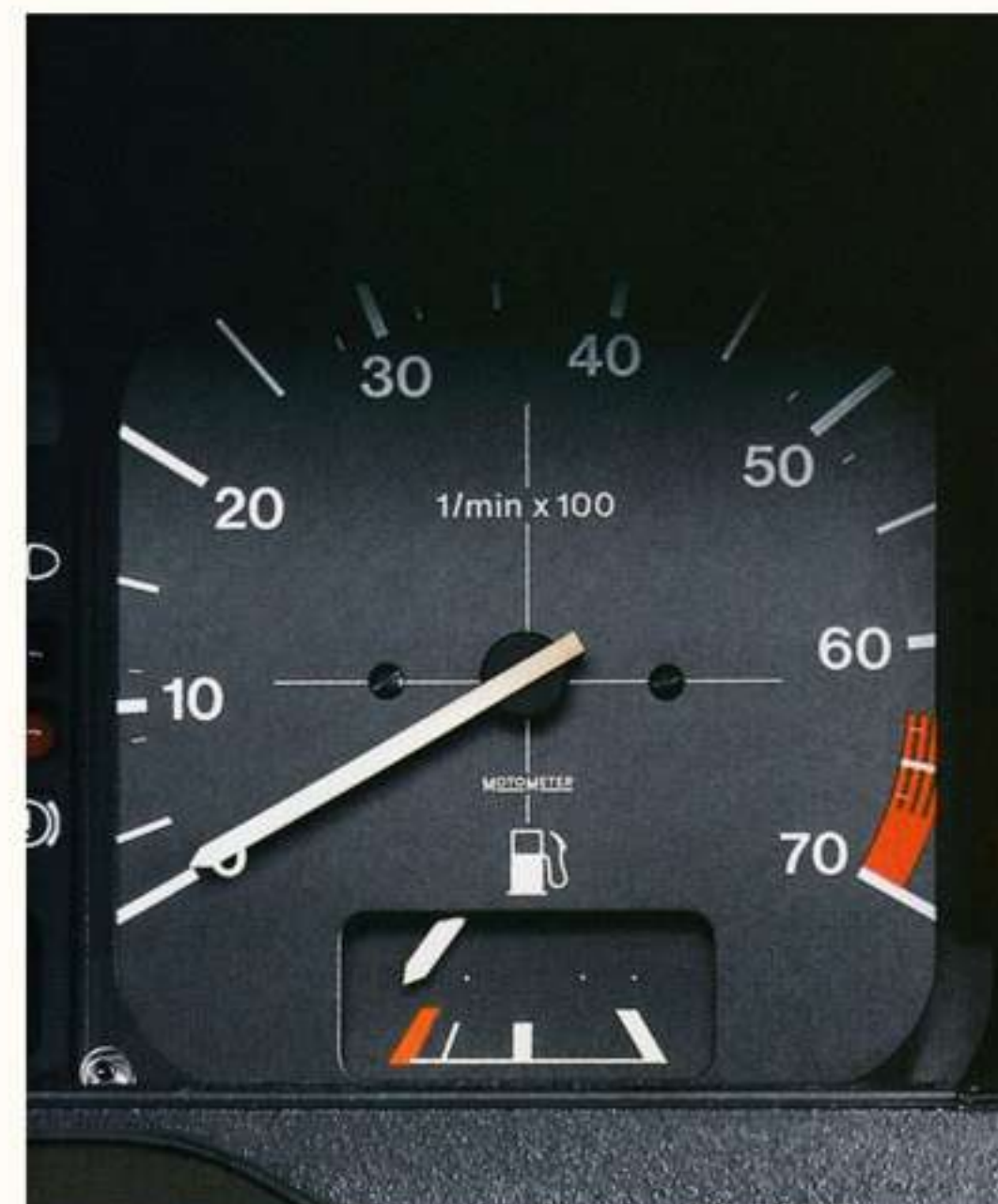
Der Drehzahlmesser. Erleichtert nicht nur das Fahren im optimalen Drehzahlbereich, sondern kann durchaus auch ein Instrument zum Kraftstoffsparen sein.
