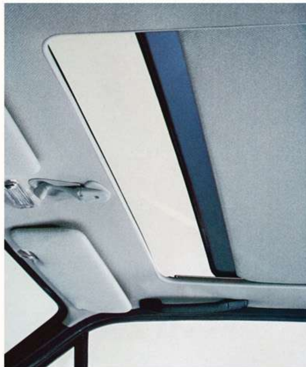
Das Schiebedach. Mit selbstaufstellendem Windabweiser gegen Zugluft.
