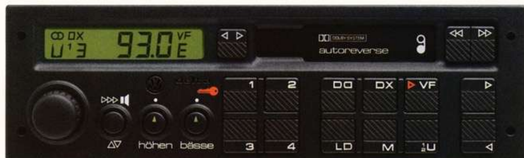
Das Radio-Cassettengerät „delta“. Mit UKW-Stereo-/MW-Empfangsteil, 4 Stationstasten für 8 UKW-/4 MW-Sender, Verkehrsfunktaste mit sich automatisch aktivierender Verkehrsfunkdurchsage, unabhängig vom eingestellten Sender (Travel-ARI), Sendersuchlauf, geschwindigkeitsabhängiger Lautstärkenanpassung (GALA), Stereo-Cassettenteil mit schnellem Vor- und Rücklauf, Autoreverse, Dolby und automatischer Bandsortenerkennung, Diebstahlsicherungs-codierung, Tipptastenbedienung, 3 Lautsprechern.
