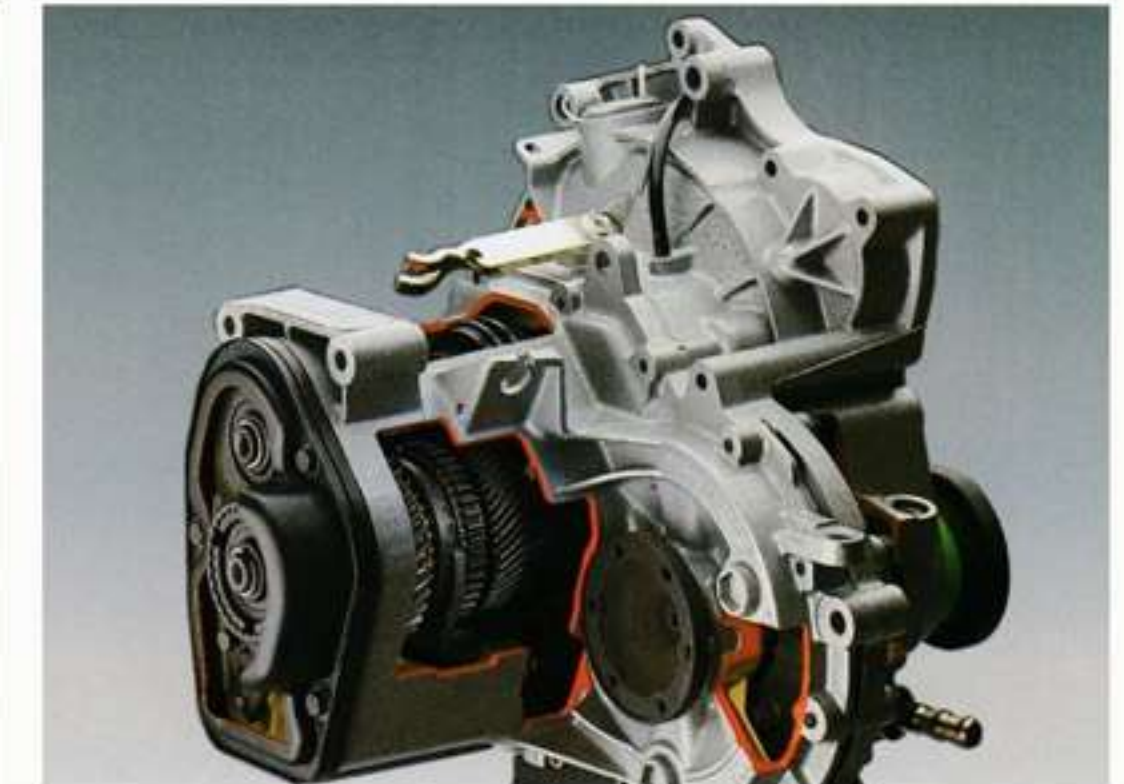
Das 5-Gang-Schaltgetriebe. Neben den speziellen Vorteilen eines 5-Gang-Getriebes (Drehzahlabsenkung mit sich daraus ergebender Geräusch- und Verschleißminderung sowie Kraftstoffersparnis) sind hier die Antriebswellen mit Kegelrollenlagern besonders robust gelagert, mit dem Vorteil der noch höheren Beanspruchbarkeit und Lebensdauer.
