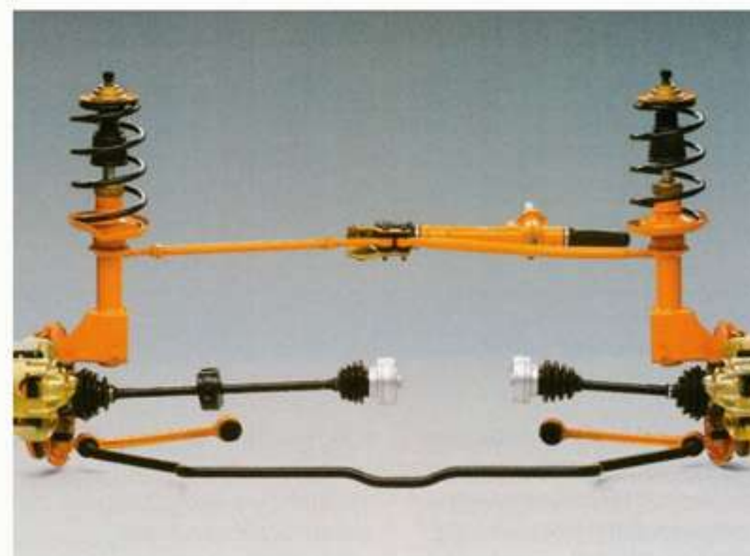
Die Federbein-Vorderachse. Sichere Straßenlage. Hoher Fahrkomfort. Leichte Lenkbarkeit. Zusätzlich ermöglicht der spurstabilisierende Lenkrollradius weitgehend ein Beibehalten der Fahrtrichtung, wenn der Wagen z.B. beim Bremsen mit den Rädern einer Seite auf losen Untergrund gerät.
