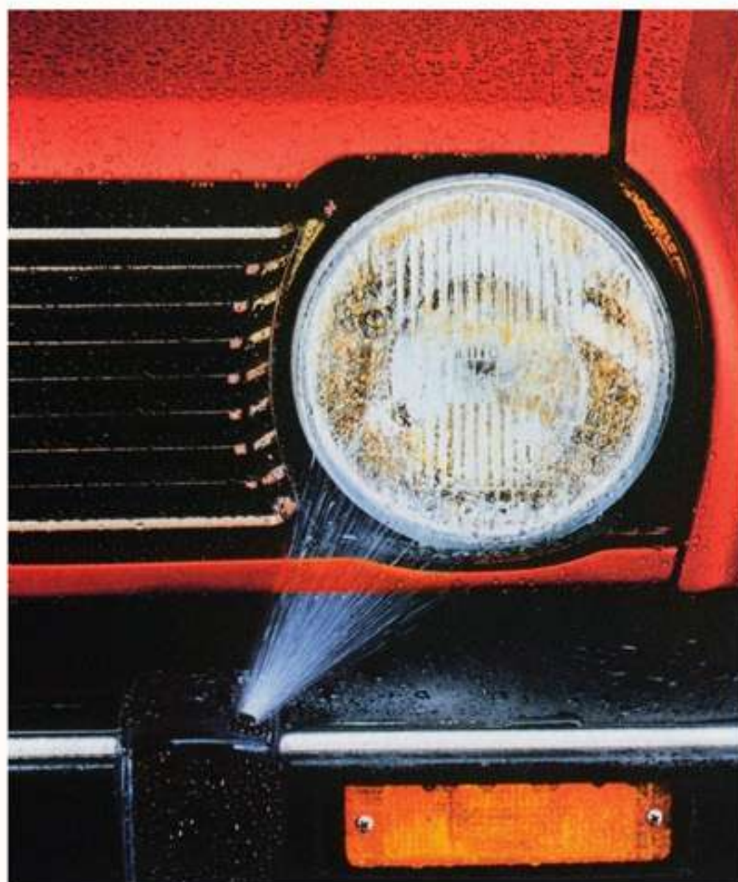
Die Scheinwerfer-Reinigungsanlage. Mehr Sicherheit durch gute Sicht.
