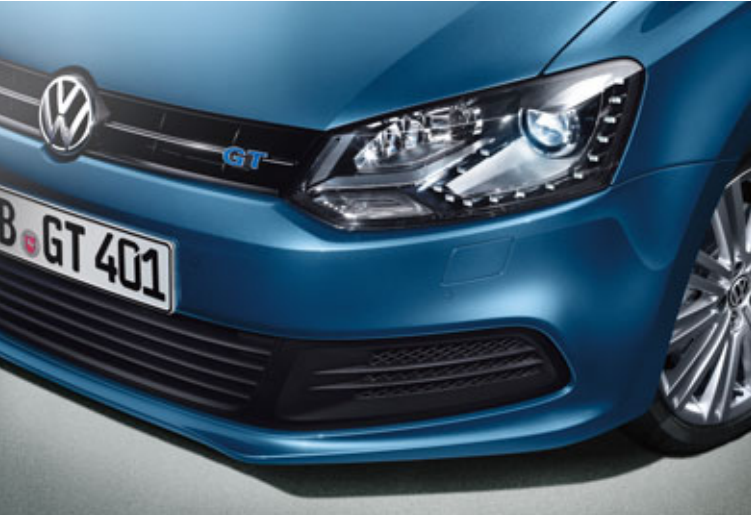
01 Verbessert die Aerodynamik und ist somit ein Beitrag zur Verbrauchssenkung: der in Wagenfarbe lackierte Stoßfänger . In Kombination mit dem schwarz lackierten Kühlerschutzgitter mit „GT“-Schriftzug sowie dem 15 Millimeter tieferen Fahrwerk ist er ein wesentlicher Bestandteil der auffälligen Fahrzeugoptik. S
