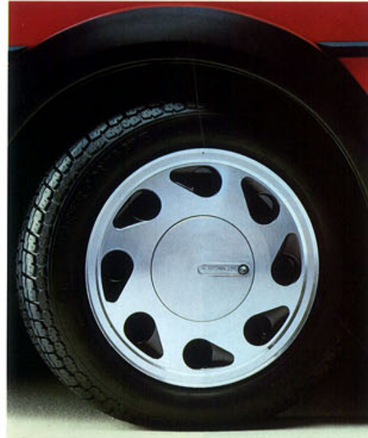
Das Leichtmetallrad 6 J x 14. Mit Mittensabdeckung und Breitreifen der Größe 185/60 R 14. Sportliches Design. Geringeres Gewicht.
