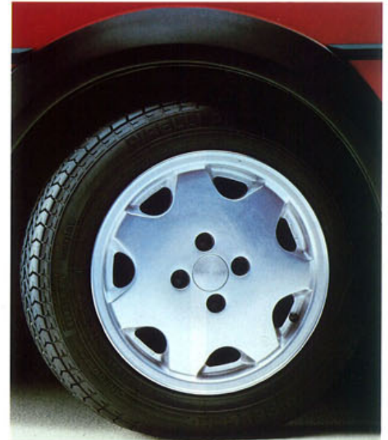
Das Leichtmetallrad 6 J x 14. Mit Breitreifen der Größe 185/60 R 14. Geschmiedet, eloxiert und poliert. Starke Optik.
