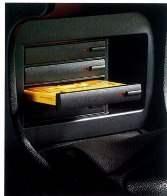
Die beleuchtete Cassettenablage. Mit optischer Belegungsanzeige und Spulen-arretierung gegen Bandsalat.
