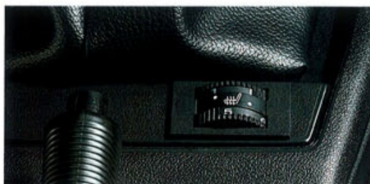
Die Sitzheizung. Spricht besonders schnell an, dadurch behagliches Sitzen, insbesondere bei Kaltstart im Winter. Temperatur kann für beide Vordersitze getrennt geregelt werden.
