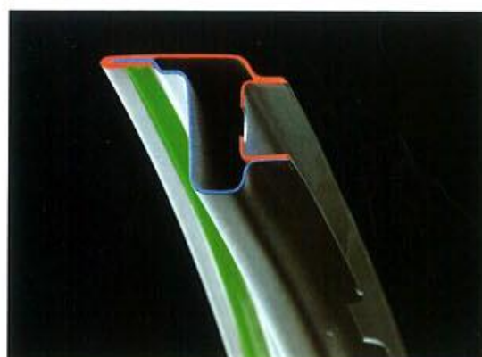
Die Karosserieabdichtung. An stark belasteten Innenkanten von Motorraumklappe, Türen und Heckklappe werden die Bleche gefalzt und miteinander verklebt. Dadurch wird Kontaktkorrosion zwischen den Blechen verhindert. Damit keine Feuchtigkeit eindringen kann, werden die Falze mit einer PVC-Abdichtung versiegelt.
