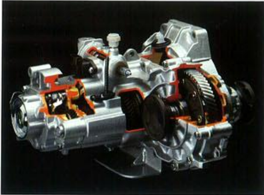
Das 5-Gang-Schaltgetriebe. Neben den speziellen Vorteilen eines 5-Gang-Getriebes (Drehzahlabenkung mit sich daraus ergebender Geräusch- und Verschleißminderung sowie Kraftstoffersparnis) sind hier die Antriebswellen mit Kegelrollenlagern besonders robust gelagert, mit dem Vorteil der noch höheren Beanspruchbarkeit und Lebensdauer.
