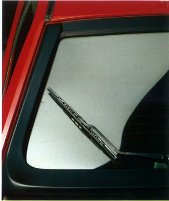
Der Heckscheibenwischer. Heckscheiben-Wasch-Wisch-Anlage mit Intervallschaltung. Für Fahrer, die in allen Verkehrslagen freie Sicht nach hinten behalten wollen.
