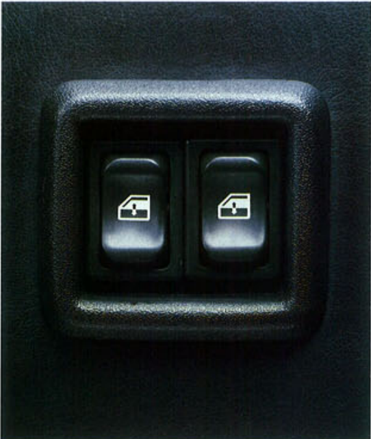
Die elektrischen Fensterheber. Die Türfenster lassen sich bei eingeschalteter Zündung per Knopfdruck öffnen und schließen.
