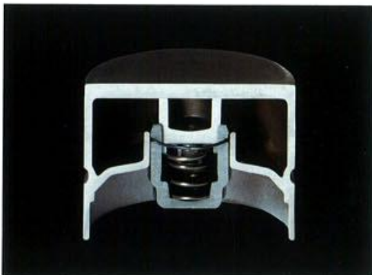
Die hydraulischen Tassenstößel. Diese Tassenstößel sind wartungsfrei und bewirken praktisch bei jeder Nockenwellenumdrehung ein korrektes Ventilspiel mit allen sich daraus ergebenden Vorteilen.
