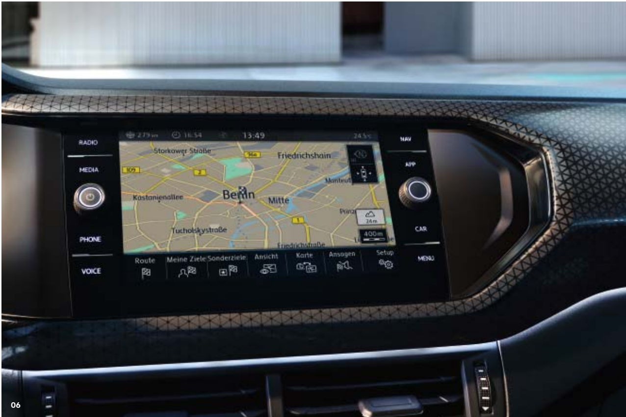
06 Das Navigationssystem „Discover Media“ für das Radio „Composition Media“ ist mit einem 20,3 cm (8 Zoll) großen TFT-Farbdisplay, installiertem Kartenmaterial für Europa, einem Touchscreen mit Annäherungssensorik und einem MP3-, AAC- und WMA-fähigen CD-Player mit sechs Lautsprechern ausgestattet. Zudem verfügt das System über zwei SD-Kartenslots, eine USB-Schnittstelle sowie eine Bluetooth-Anbindung für Mobiltelefone. Und mit den mobilen Online-Diensten von Car-Net sind Sie auch unterwegs bestens vernetzt. SO
