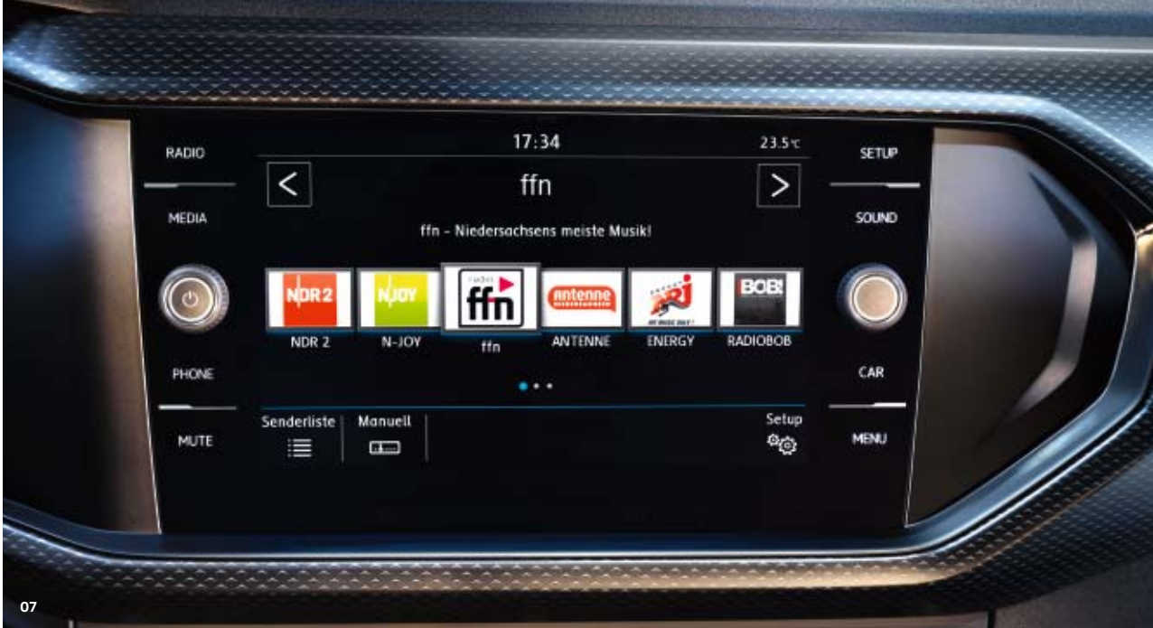
07 Das Radio „Composition Media“ verfügt über ein 20,3 cm (8 Zoll) großes TFT-Farbdisplay, einen Touchscreen mit Annäherungssensorik und einen MP3- und WMA-fähigen CD-Player. Die sechs Lautsprecher machen das Ganze zum Multimediaerlebnis. Zudem besitzt es einen SD-Kartenslot, eine USB-Schnittstelle und eine Bluetooth-Anbindung für Mobiltelefone. SO
