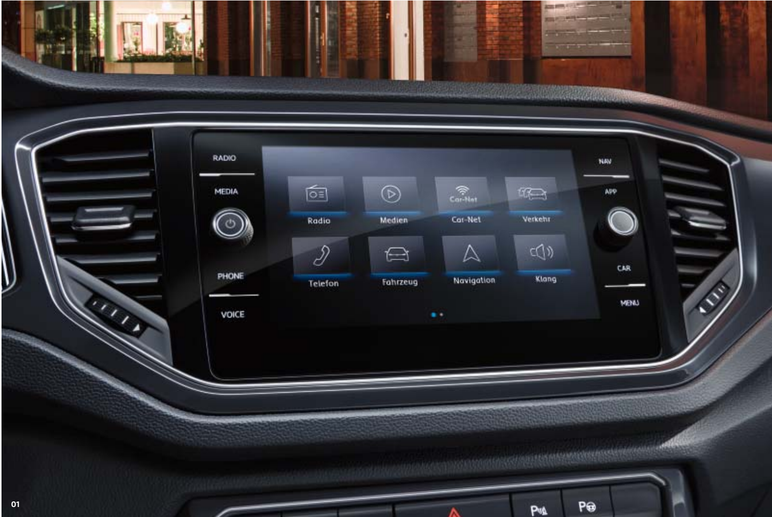
01 Das optionale Navigationssystem „Discover Media“ ist mit einem 20,3 cm (8 Zoll) großen Touchscreen-Farbdisplay ausgestattet. Freuen Sie sich außerdem über sechs Lautsprecher, FM-Radioempfang, ein CD-Laufwerk, das Musik auch im MP3-, AAC- und WMA-Format abspielt, zwei SD-Kartenslots, eine USB-Schnittstelle sowie eine Telefonschnittstelle über Bluetooth. SO
