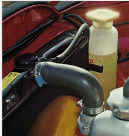
Geschlossene Kühlanlage, gefriersicher bis zu -40^{\circ}
