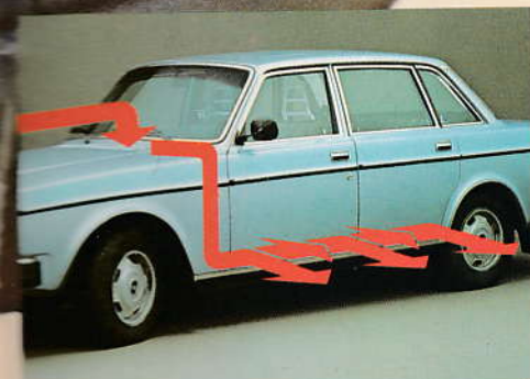
Die Turschwellen sind polyesterbehandelt und innenbelüftet. Sie sind damit optimal gegen Rost geschützt.
