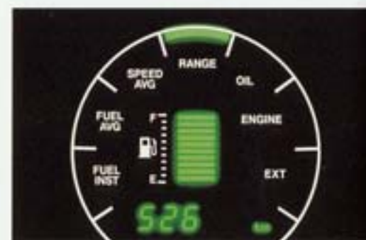
Reichweite. Errechnet die verbleibende Reichweite auf Basis des noch vorhandenen Kraftstoffs und des durchschnittlichen Kraftstoffverbrauchs.
