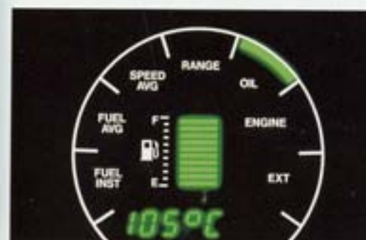
Motoröltemperatur. Einschließlich COLD- und STOP-Warnanzeige. Anzeige der aktuellen Öltemperatur zwischen 50° und 140° C.
