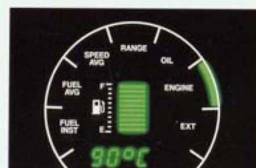
Kühlwassertemperatur. Wie bei der Überwachung der Öltemperatur mit COLD- und STOP-Warnanzeige. Anzeige der Kühlmitteltemperatur zwischen 50° und 115° C.
