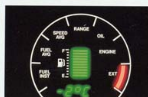
Außentemperatur. Diese Funktion warnt automatisch bei niedrigen Temperaturen und Gefahr der Glatteisbildung.
