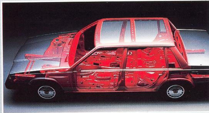
Die Sicherheitszelle aus widerstandsfähigem Stahl schützt die Insassen.
