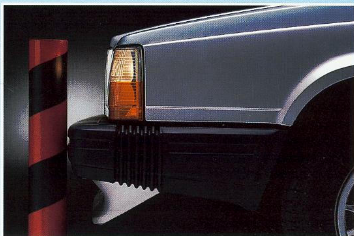
Bei Geschwindigkeit bis zu 4 km/h wird die Aufprallenergie im Falle eines Zusammenstoßes von den Stoßstangen vollständig absorbiert.
