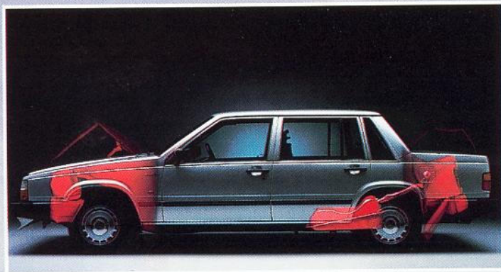
Knautschzonen vorn und hinten schützen die Insassen. Der Kraftstoff-tank ist an gut geschützter Stelle vor der Hinterachse angebracht.
