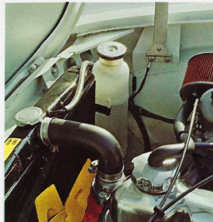
Geschlossene Kühlanlage, gefriersicher bis zu -40°
