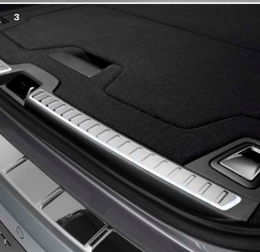
1. Stahlgitter, Gepäckraumteiler, Hundetür, Gepäckraumwanne 2. Gepäckraummatte, Kunststoff 3. Beleuchteter Ladekantenschutz 4. Schmutzfänger, vorn 5. Semielektrisch einklappbare Anhängerkupplung
