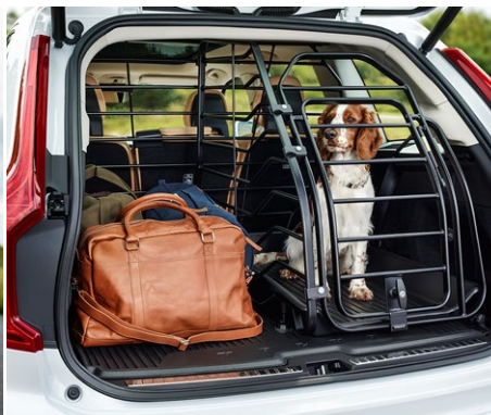
Das Stahlgitter bewahrt Ihr Gepäck davor, bei einer Kollision nach vorne geschleudert zu werden. Die längslaufende Laderaum-Trennwand teilt Ihren Kofferraum in zwei Teile und das Hundegitter sorgt dafür, dass Ihr Haustier da bleibt, wo es hingehört: in Sicherheit.
