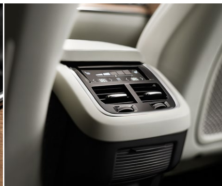
Die Vier-Zonen-Klimaanlage lässt sich über den zentralen Touchscreen oder einen separaten Touchscreen am Ende der Tunnelkonsole regulieren.
