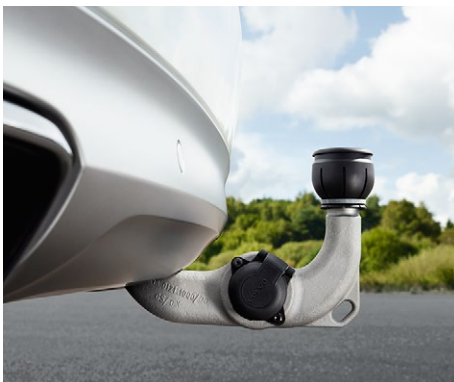
Die halbelektrische Anhängerkupplung können Sie ganz einfach auf Knopfdruck lösen und verstauen. So ist sie nur sichtbar, wenn Sie sie auch wirklich brauchen.
