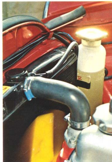
Slutet kylsystem, fryssäkrat ner till -40^{\circ}
