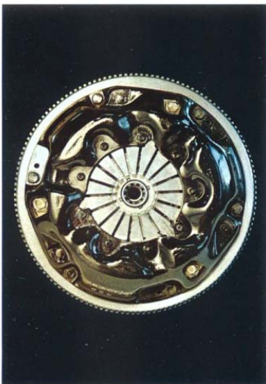
Solfjäderskoppling ger lågt pedaltryck
