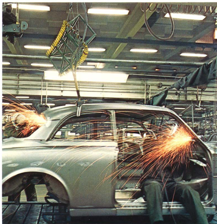
Noggrann undersökning av svetsarna på bäst rostskydd
