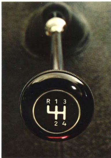
Golvväxelspak med distinkta lägen
