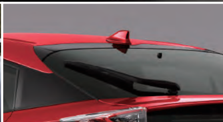
Antena con forma de aleta de tiburón
