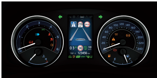
Color Thin Film Transistor ( TFT ) Multi - Information Display شاشة عرض معلومات متطورة
