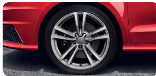
Llantas de invierno de aleación en diseño de 5 radios paralelos (diseño S) tamaño 7,5 J x 17 con neumáticos 215/40 R 17 1 , velocidad máxima tolerable 240 km/h, no aptas para cadenas. (no disponible para España)
