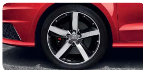
Llantas de invierno de aleación en diseño de 5 brazos con elementos decorativos en negro ultrabrillante, tamaño 7,5 J x 17 con neumáticos 215/40 R 17 1 , velocidad máxima tolerable 240 km/h, no aptas para cadenas. (no disponible para España)
