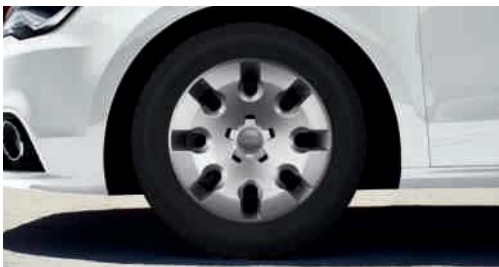
Llantas de acero con tapacubos integrales Tamaño 6 J x 15 con neumáticos 185/60 R 15 (exclusivo en el 1.2 TFSI Attraction); tamaño 6,5 J x 15 con neumáticos 205/55 R 15.
