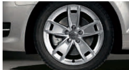
Llantas de invierno de aleación en diseño de 5 brazos tamaño 6 J x 17 con neumáticos 205/50 R 17, aptas para cadenas, velocidad máxima tolerable 210 km/h. (No disponible en España).
