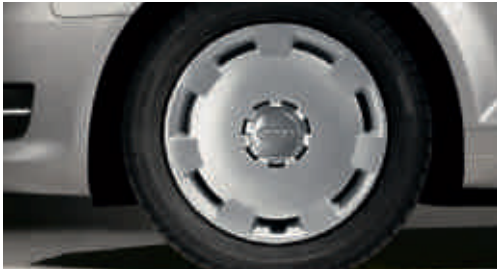
Llantas de acero, incluye tapacubos integrales tamaño 6,5 J x 16 con neumáticos 205/55 R 16.
