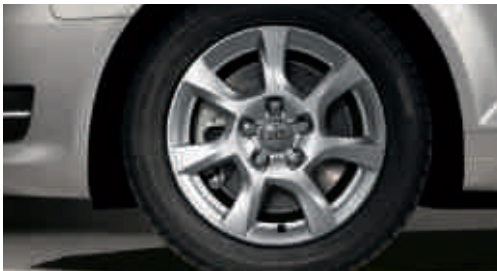
Llantas de aleación en diseño de 7 radios tamaño 6,5 J x 16 con neumáticos 205/55 R 16. (de serie en Attraction)
